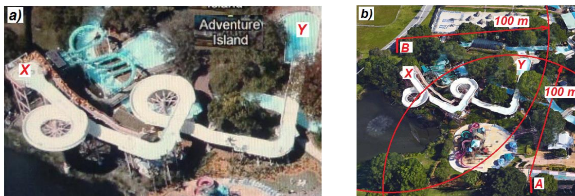
Rys. 2. 10. Ilustracja: a) zjeżdżalni z krańcem górnym X i dolnym Y; b) rozmieszczenia zwołów aktywnych” A i B oraz zasięgu stref chronionych [7].
